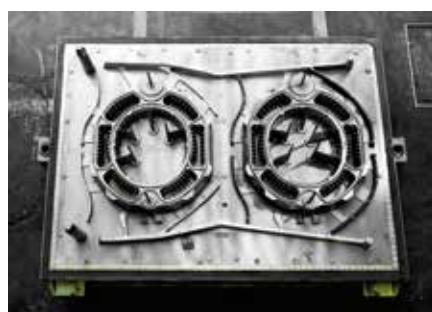
Mit einer CNC-gesteuerten Fräsmaschine fertigen wir innerhalb kürzester Zeit hochwertige Modelleinrichtungen an.
