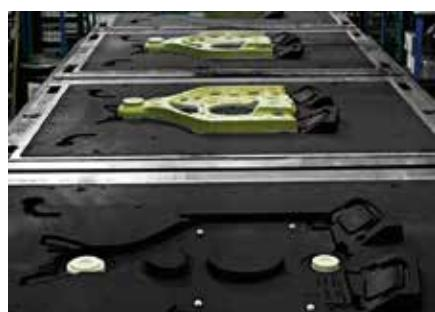
Unser Know-how umfasst die Fertigung von kernintensiven Gussteilen.
